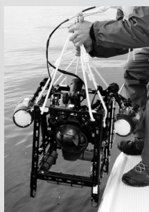
水中撮影カメラ「ゆりかご1号」。海に沈めて船上からシャッターを押す。ホームセンターで買った材料で記者が手作りした=2012年10月2日(中国新聞社提供)
