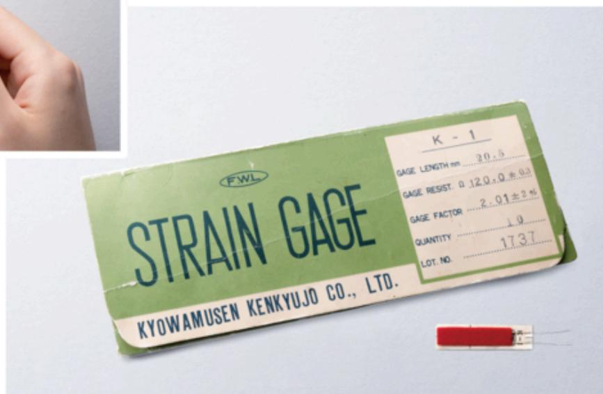
ひずみゲージ K-1型
